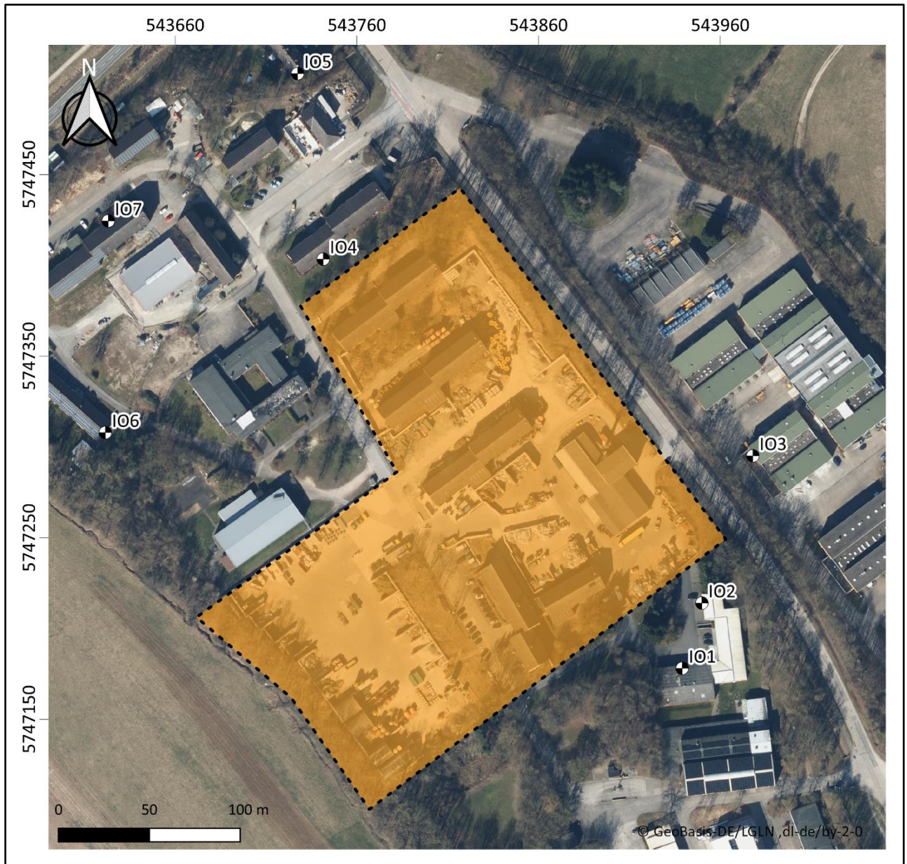
Abbildung 1: Lage der Flächenschallquelle zur Berechnung der Immissionsrichtwerte
